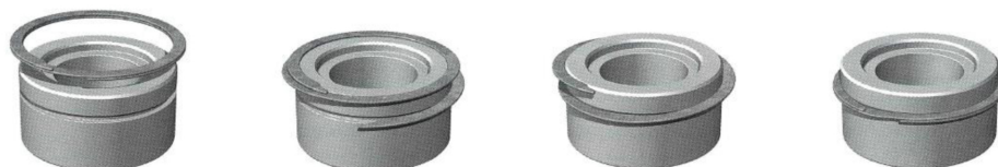
Рис. 53: Монтаж стопорного кольца внутреннего кольцевого фильтра
